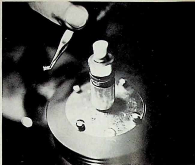
Zender voor golflengten van enige centimeters m.b.v. gunn elementen.
